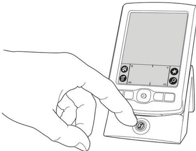
**Windows:** Setzen Sie den Handheld bei der entsprechenden Aufforderung in die Docking-Station ein und drücken Sie die HotSync-Taste.
